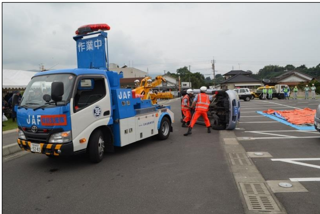
【横転車両引き起こし作業風景】
