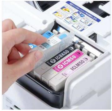
本製品は、プリンタの定期メンテナンス用のクリーニング液とカートリッジのセットです。プリンタのヘッドノズルは、乾燥したりホコリが入ってしまったりすると目詰りしてしまうことがあります。その場合、通常のヘッドクリーニングでも改善しなければ、修理費が高くついてしまいます。しかし、本製品を使用し定期的にメンテナンスを行うことで、プリンタの故障を事前に防止することができます。直接ヘッドに液を注入するタイプのとは違い、カートリッジに液を注入してからプリンタにセットするタイプなので、プリンタ内部に液が漏れる心配はありません。また、カートリッジをプリンタにセットし、ヘッドクリーニングを2回行うだけの操作なので、手間なく手軽にメンテナンスを行うことができます。
