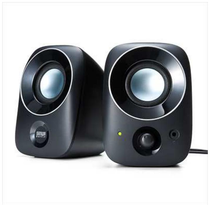
本製品は、USB ポートから電源を供給する USB 給電方式のスピーカーです。大きさはお好みの場所に設置できる絶妙なサイズのコンパクト設計です。音が耳にダイレクトに届くやや上向きのスピーカーユニット採用で、小さな音量でもはっきりと明確に聞き取る事ができます。最大出力は約 4W で、USB 電源ながらパワフルで迫力ある再生が可能なので、音楽や映画の鑑賞に最適です。電源は USB からの給電の為、AC 電源が不要でケーブルが少なく簡単にきれいに設置できます。音源入力端子はさまざまな機器に対応する 3.5mm ステレオミニプラグ仕様で、テレビでも Windows でも Mac でも音声出力端子につなぐだけで音楽を楽しめます。本体前面には深夜や周りに気を使う環境にも便利なヘッドホンジャックを搭載しています。パソコンやテレビのディスプレイに影響を与えない防磁型です。
