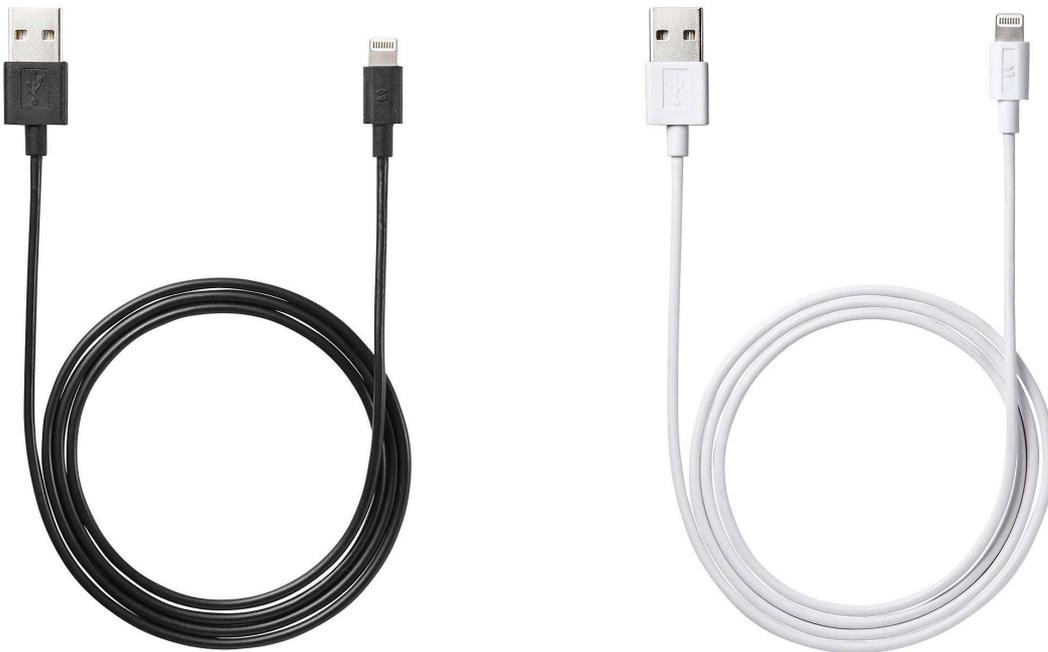
この製品は、Apple 社の MFI 認証 (Made For iPhone) を取得し、iPhone6、iPad Air、iPad mini などに対応した Lightning USB ケーブルです。iPhone・iPadなどをパソコンに接続してデータの通信や充電ができます。ケーブル部は直径約 2.6mm の細径ケーブルを採用、Lightning コネクタ部は 9.0×5.4mm と非常にコンパクトなため、取り回しがしやすくなっています。ケーブル長は 1m、ブラックとホワイトの 2 カラーから選べ、安心の <20 ヶ月保証> 付きです。
