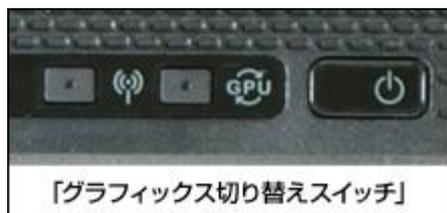
グラフィックス切り替えスイッチを搭載し、ボタン一つで使用するグラフィックス機能を切り替えることが可能となっています。例えば、自宅や職場などで動画編集や画像加工、オンラインゲームなど、グラフィックス性能を必要とする作業を行う場合には「ATI Mobility Radeon™ HD 545v」を使用し、外出先では「インテル® HD グラフィクス」を使用することによって消費電力を抑えバッテリー駆動時間を延ばすなど、使用するシーンに合わせたハードウェアコントロールを実現します。
