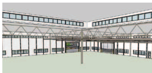
【越屋根（工場内部）】
