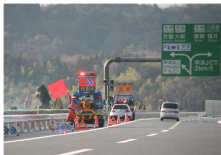
本線上での停車は危険！JAFでは安全のため高速道路での作業時、後方警戒を実施しています。
