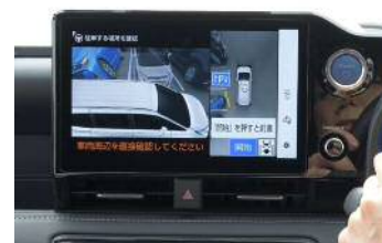
ディスプレイをタッチして操作する パーキングアシスト
