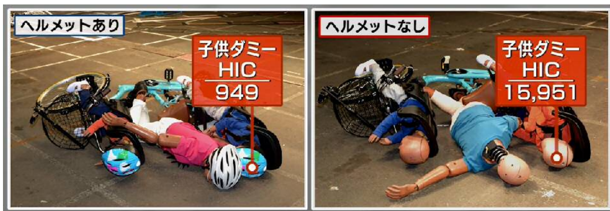
ヘルメット着用有無による後席子供ダミーの頭部損傷基準値（HIC）
