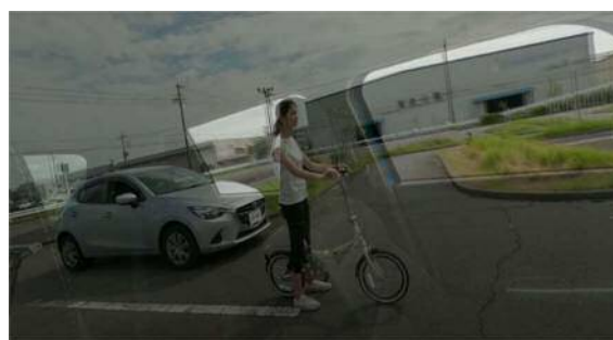
徐々に車体が透けてクルマの死角に自転車とクルマを確認できます
