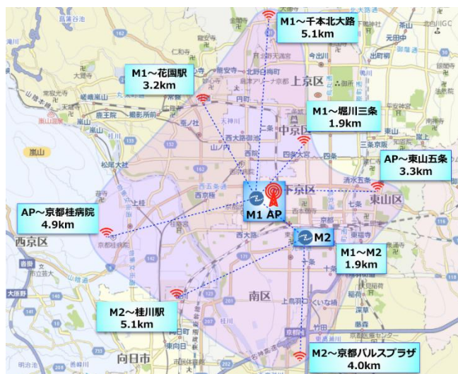
【京都市内 ZETA LPWA データ通信インフラ構築状況】
