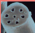
繊維1本1本に7つの空気孔を持つので、かさ高と保温性を実現
