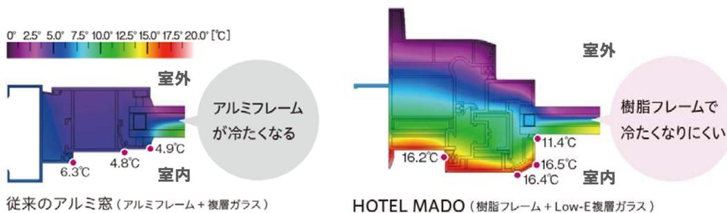
【算出条件】(JIS A 2102設定値) 室外側温度:0℃、室内側温度:20℃、湿度:50%、露点温度:9.3℃、
