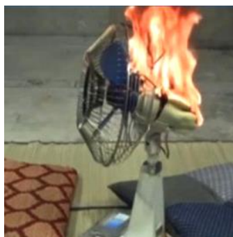
故障により過熱、発火する扇風機
