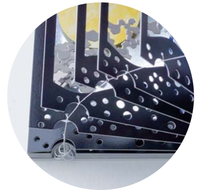
ページとページを等間隔に保つため、1ページずつ手作業で糸をつけている。
