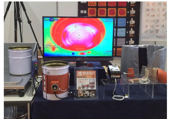
スリーハイ製品を利用したヒーターでパール缶を温めている実験の様子。画面はサーモグラフィで熱の温度を示しているもの
