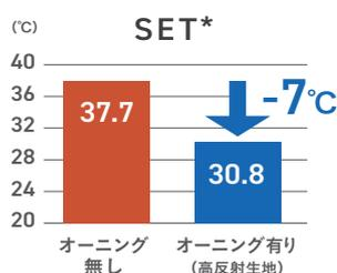
2016年9月に埼玉県桶川市試験場にて測定。SET\*(エス・イー・ティー・スター標準有効温度)は、温度、湿度、風速、輻射の影響を統合した指標で、人が静止した状態で感じる体感温度を表します。
