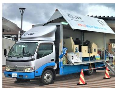
時速5キロのシートベルト衝突体験ができるコンベンサー
