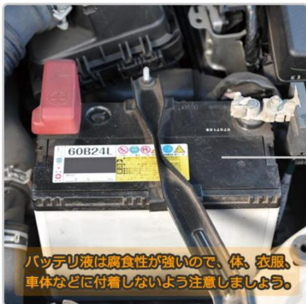
バッテリーの液量が規定の範囲（UPPERとLOWERの間）にあるかを車両を揺らすなどして点検します。
