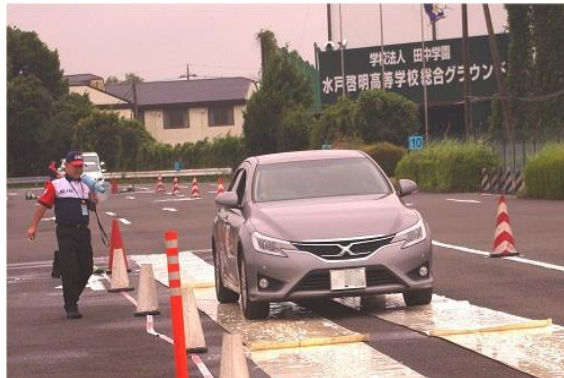
▲滑りやすい路面での急ブレーキ
