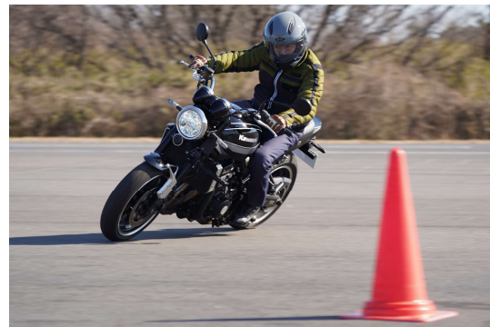
旋回テストで速度ごとの回転半径を測定
