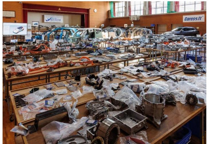
それぞれの車種に搭載されている部品を比較しやすいよう、モーター・インバーターなどの EV パワートレインシステム、バッテリー・空調の温度管理を担うサーマルマネジメントシステム、骨格部品や内外装部材など、部品群ごとにカテゴライズされた展示に変更しています。また、Tesla 社や中国メーカーの EV など、完成車を 3 台ご用意しております。話題となっている最新 EV に試乗し、学校の敷地内を実際に走行していただくことも可能です。
