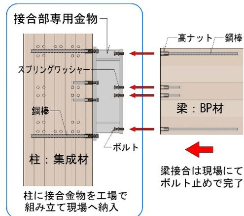
従来の木造接合方法である埋め込みロッドによる「グルード・イン・ロッド接合」(GIR 工法)は、鋼棒の挿入や接着剤の注入をすべて現場で行う必要があり、施工に多大な時間と手間がかかります。そこで当社では、新たな接合法「タカマツ・ウッド・クイックジョイント工法」(TWJ 工法)を独自に開発しました。この工法では、接合専用治具を取り付けた柱と、工場であらかじめ鋼棒・高ナットを挿入し接着剤で固定した梁を現場に搬入し、現場ではボルトを締結するだけで完了します。これにより、現場作業を大幅に省力化でき、GIR 工法に比べて大幅な工期短縮が見込めます。
