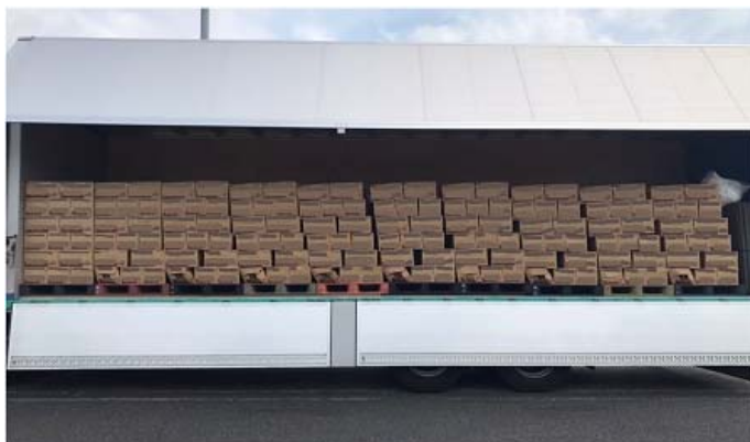
写真:緩衝材を使用しないと荷崩れが起きてしまう
