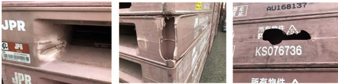
写真:フォークリフトの爪の衝突などによる破損の例
