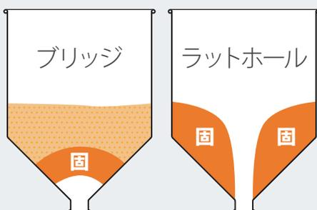
粉の圧力などで排出口の上部がアーチ状に閉塞し排出が止まる「ブリッジ」や粉の圧力と側面の摩擦により粉が固まり排出口の上部だけ粉が抜ける「ラットホール」などを解消し、粉体の排出を効率化します。
