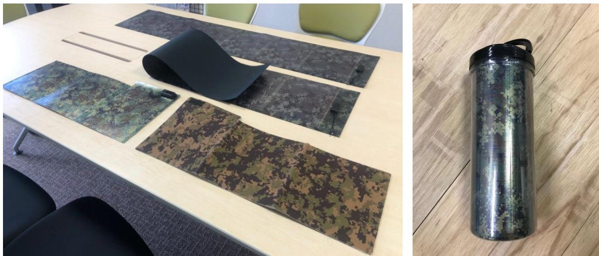
迷彩柄の加飾フィルム（左）を活用し、迷彩柄の太陽電池を製作。屋外や非常時にスマートフォンに直結して充電でき、ポータブル電源を充電できるようなアウトドアグッズ（右）を試験的に製作。
