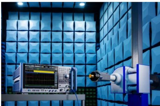
キャプション : 最高44 GHzに対応の新しい高ゲインEMIマイクロ波アンテナなら、FR2帯域でもデバイスのEMI測定が可能です。
