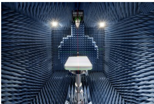
Caption: R&S TS8991 アンテナ試験システムで特性評価されるGreenerwaveのESAアンテナ。
