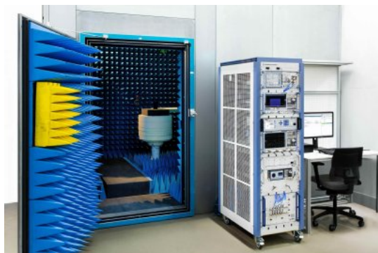
Caption: R&S TS8991 OTA性能試験システムの構成例
