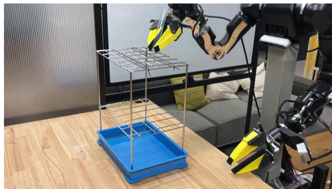
対象物の向きを変えて、ラックに挿入する様子
