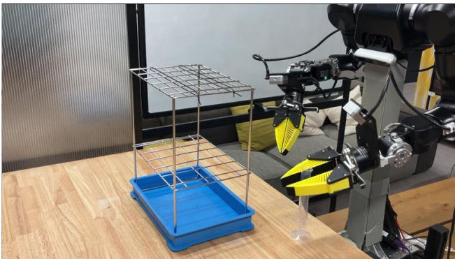
双腕ロボットが左のアームで対象物をつかみ（写真左）、右のアームに持ち替える（写真右）様子
