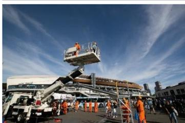
道路と線路の両方を走れる架線整備車が登場します！電線の点検に使われるため、車体上部の作業台を上げ下げできる構造になっている特殊車両です！イベント当日は車輪の出し入れ操作体験を実施します！撮影も可能ですので、是非ご参加ください！
