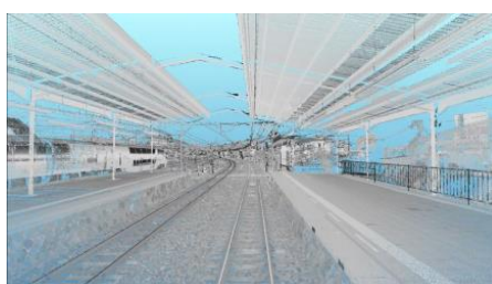
実証実験で取得した3次元点群データ (伊豆急下田駅)
