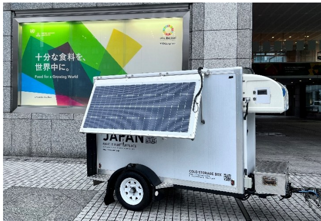
※オフグリッド Cold Storage Box Portable（日本国内モデル）国連大学での撮影
