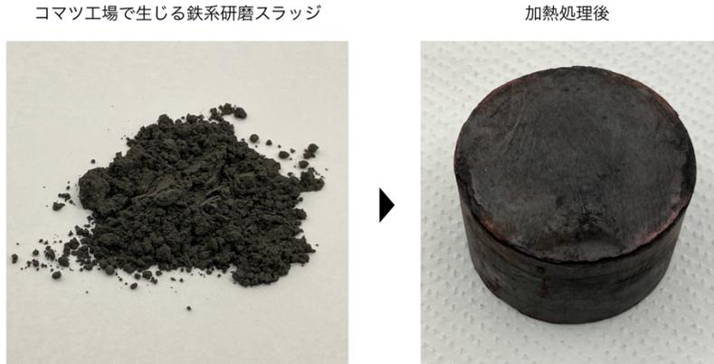
■ 図1 鉄系研磨スラッジと加熱処理後の状態
