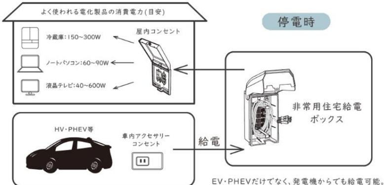
ガレージから安心して電気が使える非常用住宅給電ボックス。
