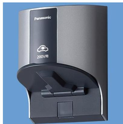
アイダ設計では、地震や台風など近年多発する自然災害等による停電などの非常時に、住まう人を守るべく、EV・PHEV車から電力を供給する為の「住宅用安心給電キット」と、EV・PHEV車を充電する専用コンセント（200V用）をセットにした新たなオプションパックをつくりました。「住宅用安心給電キット」は非常用住宅給電ボックスと屋内コンセントの構成で、停電時にはガレージに置いたEV・PHEV車内のアクセサリーコンセントに非常用給電コードを接続することで、専用屋内コンセントへ冷蔵庫やPC・テレビなど家電製品を接続し利用することが可能です。
