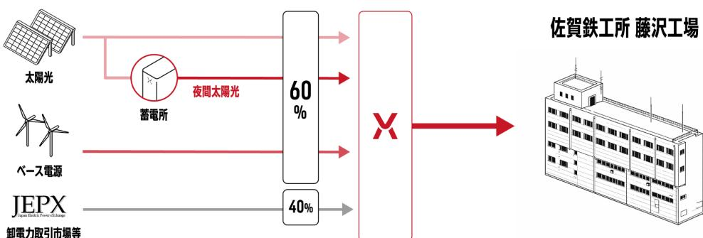
新たに電力を供給する藤沢工場は、自動車向け高強度ボルトを製造する同社の主力工場です。本サービスの導入により、同工場で使用する電力の60%を「追加性\*」のある再生可能エネルギー電源から調達し、残り40%についても卸電力取引市場等から最適調達を行うことで、環境負荷の低減と経済性の両立を図ります。
