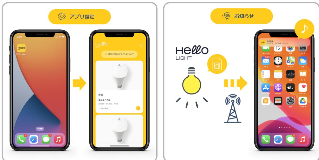
例えば、倉庫、ビニールハウスなどに設置されている電球を「Hello Light」に交換するだけで、電球が点灯したことを遠く離れた場所でも知ることができます。従来の「Hello Light」はメールによる通知でしたが、電球の点灯を音とプッシュ通知でお知らせするアプリ「Hello App」をスマホにインストールすることで、様々な音でリアルタイムに点灯を知ることができるようになります。ご自宅に余っているスマホを使って、インターフォンのような機能として利用することもできます。
