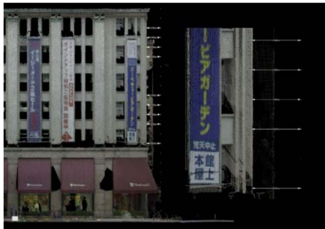
壁面移動量の比較方式（点群操作画面／Trend-Point）
