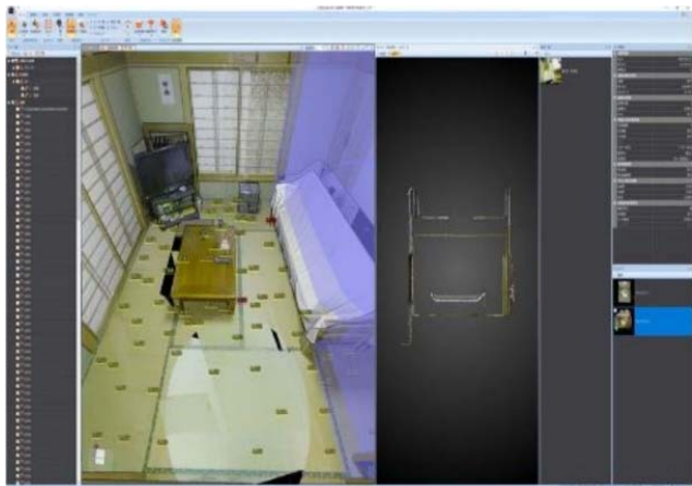
床面沈下量の比較方式（点群操作画面／Trend-Point）
