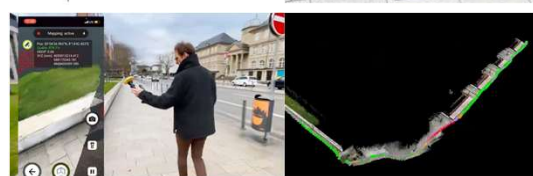
Trimble DA2と連動しGPS測定&スキャン (外部GNSS測定機あはPRIMEのみ対応)
