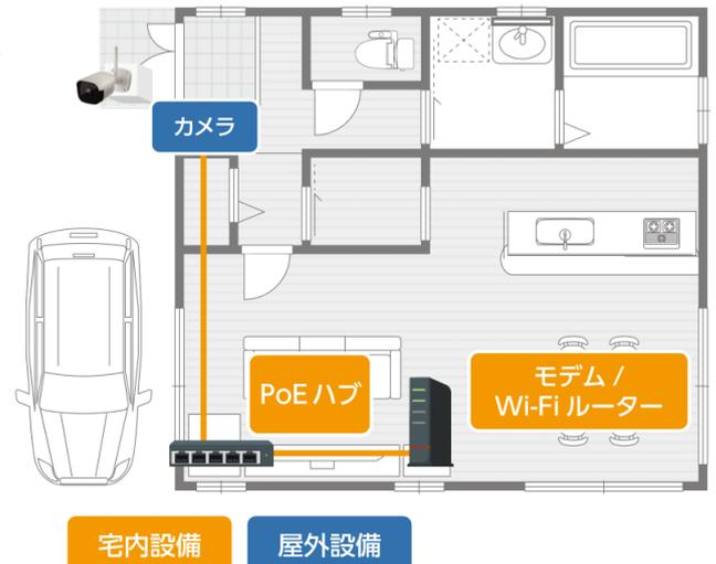
カメラとインターネットモデム・Wi-Fi ルーターが同一階にあり距離が概ね 10m 以内の場合は有線接続での設置となります。
