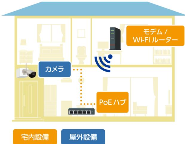
カメラとインターネットモデム・Wi-Fi ルーターが別階にある場合/同一階にあり距離が概ね 10m 以上の場合は無線接続での設置となります。
