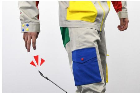
ノギスを落下させて破損する
