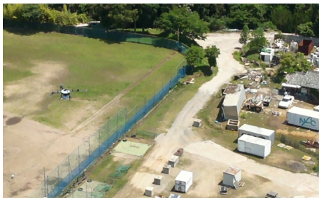
ドローンが3Dを計測する様子
