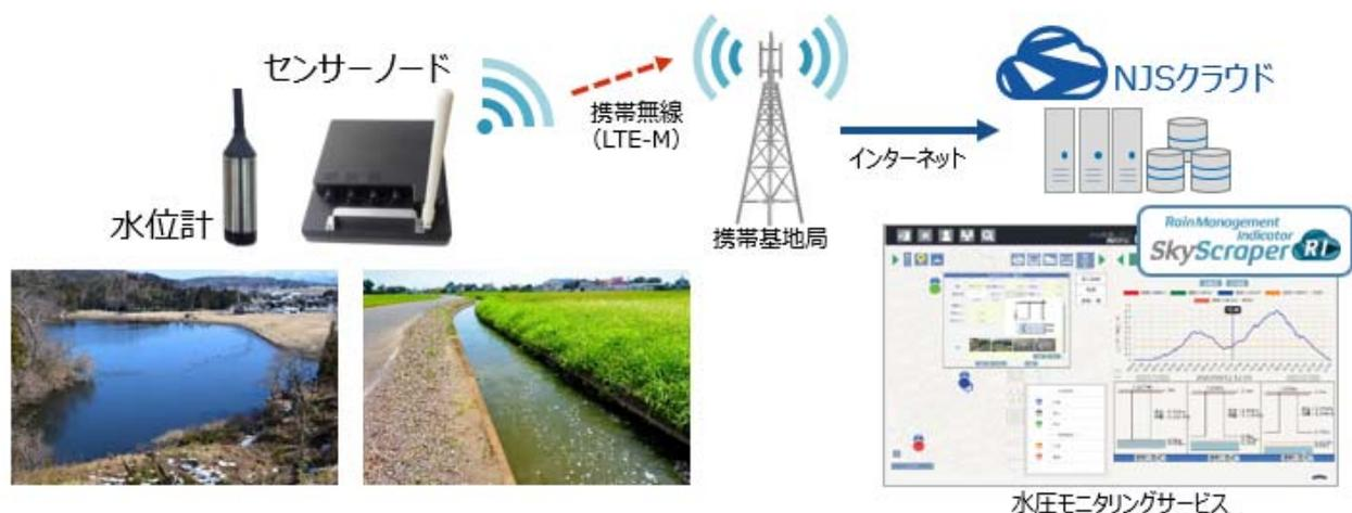
図-1 農業用システムのモニタリングサービス概要
