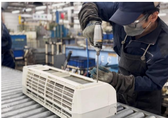
使用済みエアコンの手解体工程
