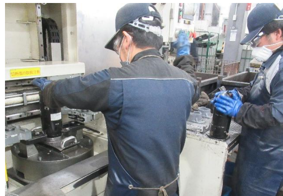
エアコンのコンプレッサーの解体工程
