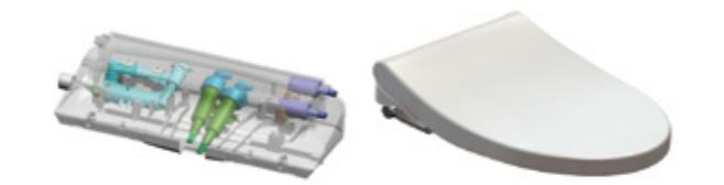
アジア市場を中心におしりを洗う文化の定着を目指し、薄型で高いデザイン性、従来機能をより低コストで提供する「エコウォッシャー」の新商品を開発。従来製品に対して高さ40%ダウンを達成し普通便座並みの薄さを実現。プラットフォーム及びアドオン設計により、外観デザイン違いの商品に対して、ベース部の共用を徹底し開発スピードが30%向上した。また、ビデありの機能違いの商品に対して、部品共用化率97%を達成。さらに、組み立てのねじレス化を進めるなど、生産効率、製造品質の安定化、コスト削減を実現した。
