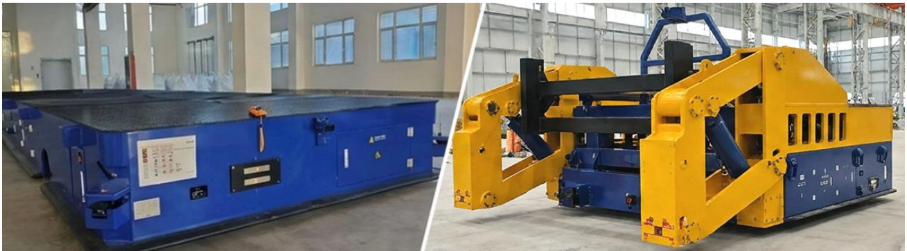
フラッドベッド型(左)、油圧リフト式輸送タイプ(右)
