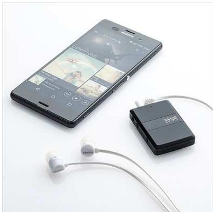
本製品は、Bluetooth の受信機と送信機の両方に使用できる Bluetooth オーディオレシーバー&トランスミッターです。切り替えスイッチで簡単に受信機モードと送信機モードの切り替えが可能です。
