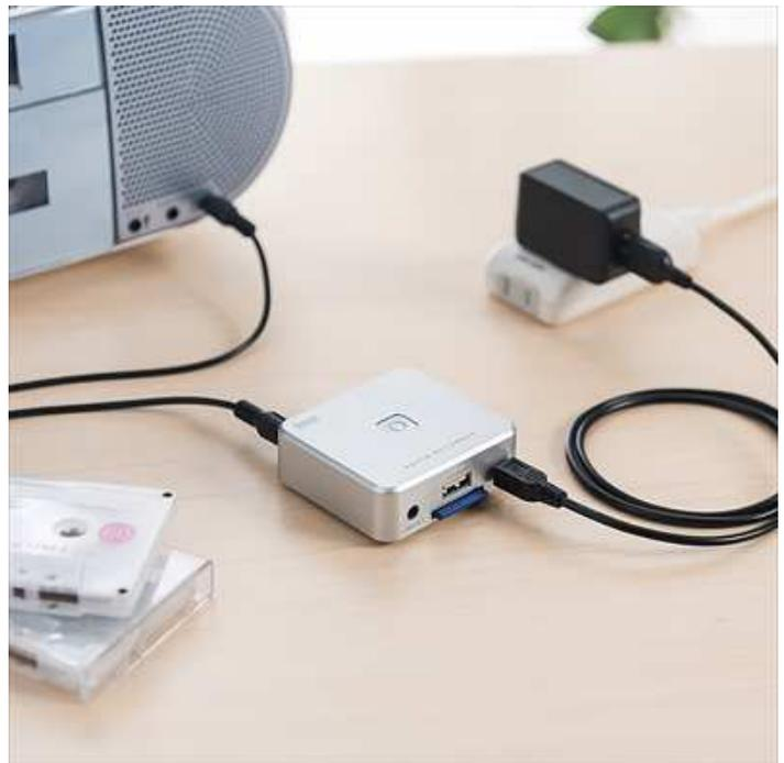
本製品は、カセットテープやラジオなどのアナログ音源を USB メモリ、SDHC カードにデジタル保存できるオーディオキャプチャーです。使用方法は、付属の AC アダプタ、USB 給電ケーブルを本体に接続し、AC アダプタをコンセントに挿し、USB メモリまたは SD カードを本体にセットします。次に再生機器のヘッドホン出力端子と本製品付属の 3.5 mm ステレオミニプラグまたは、RCA ケーブル（別売）で接続し、機器の再生を開始します。最後に、データ化したい箇所、キャプチャーを終了したい箇所でキャプチャーボタンまたはリモコンの録音ボタンを押します。本製品は、パソコンが不要で、再生したい機器とつなぐだけで簡単に使用できるところが最大のポイントです。
