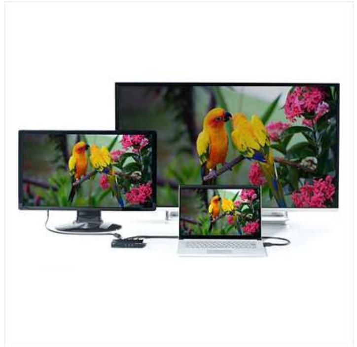
本製品は、HDMI 信号を 2 画面に同時出力できる、HDMI 分配器です。オフィスや学校などでの 2 画面出力など、様々なシーンで使用できます。4K2K（4096×2160）@60Hz（4:4:4）の解像度に対応し、美しく高精細な HDMI 信号を 2 台の 4K モニターに同時出力できます。接続された 2 台のディスプレイの EDID 情報を比較し、どちらにも対応する解像度を自動判別し、入力機器（パソコン等）に EDID 情報を伝える事が出来ます。Dolby True HD および DTS HD Master Audio にも対応しています。4K 放送の視聴が可能な著作権保護規格「HDCP2.2」に対応しております。筐体は手のひらにのるコンパクトサイズです。電源の ON・OFF スイッチ付きです。
